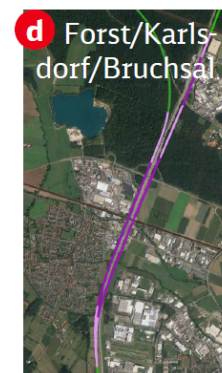
d Forst/Karlsdorf/Bruchsal Für östliche Bündelung A5 (Linienvarianten R5/R6): mit Unterquerung Raststätte Bruchsal, Autobahnkreuz, Bestandsstrecke 4132 in offener Bauweise, Querung der Autobahn bei Karlsdorf auf die Westseite Für westliche Bündelung A5 (Linienvariante R4): mit Unterquerung Gewerbegebiet Walldorf West in offener Bauweise
