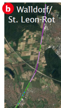
b Walldorf/ St. Leon-Rot Östliche Bündelung mit Unterquerung (offene Bauweise) des Gewerbegebiets und des Autobahnkreuzes (aufgrund Ausbauplanung Autobahnkreuz)
